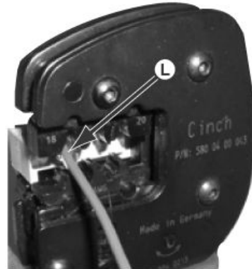
Kabel auf Anschlußklemme in Crimpzange
