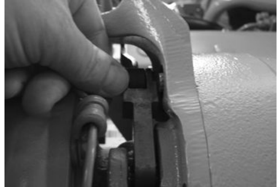
Prüfung der Beweglichkeit des Gestänges
