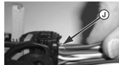
Ausbau von Anschlußklemme und Kabel
