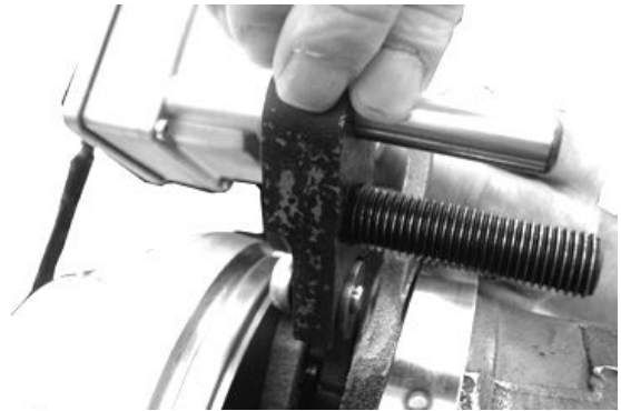
Anbringen des Sockels des VGT-Werkzeugs JDG10395 am Stellmotorarm
