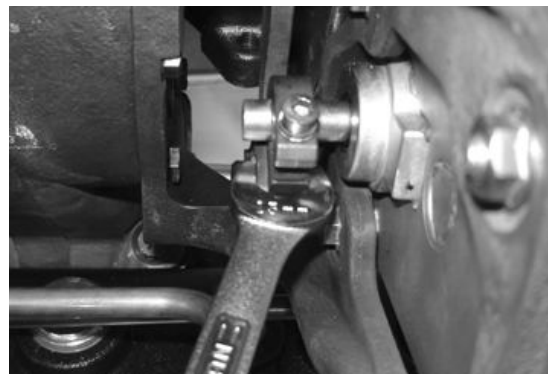
Halten des Gestänges mit einem Schraubenschlüssel
