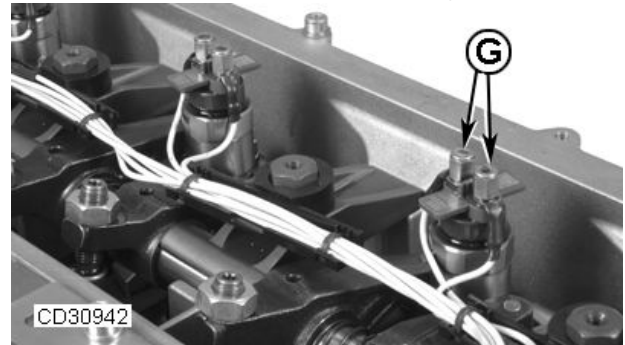
Verkabelung der Einspritzdüse anschließen
