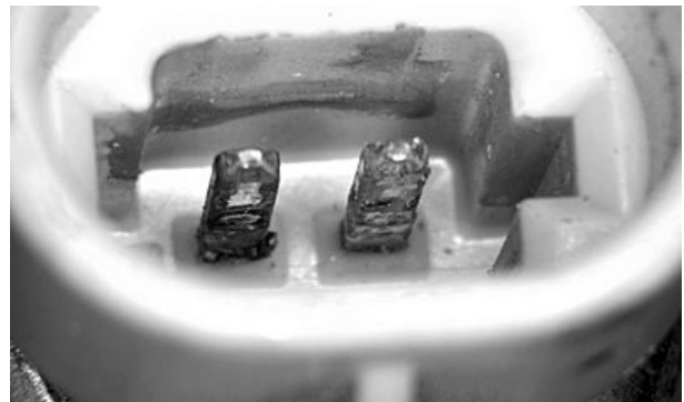
2-Stift-Stecker - Abgenutzte und korrodierte Stifte
