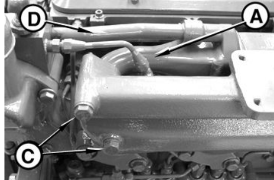
Sechskantschrauben vorne am EGR-Kühler
