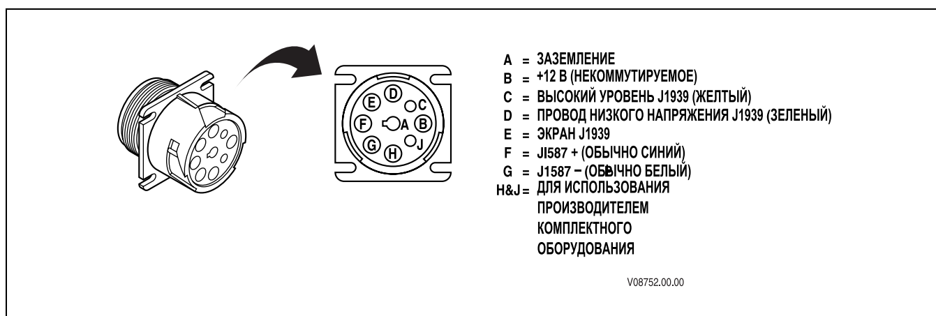
Рис. R–6. 9-контактный диагностический разъем в кабине
