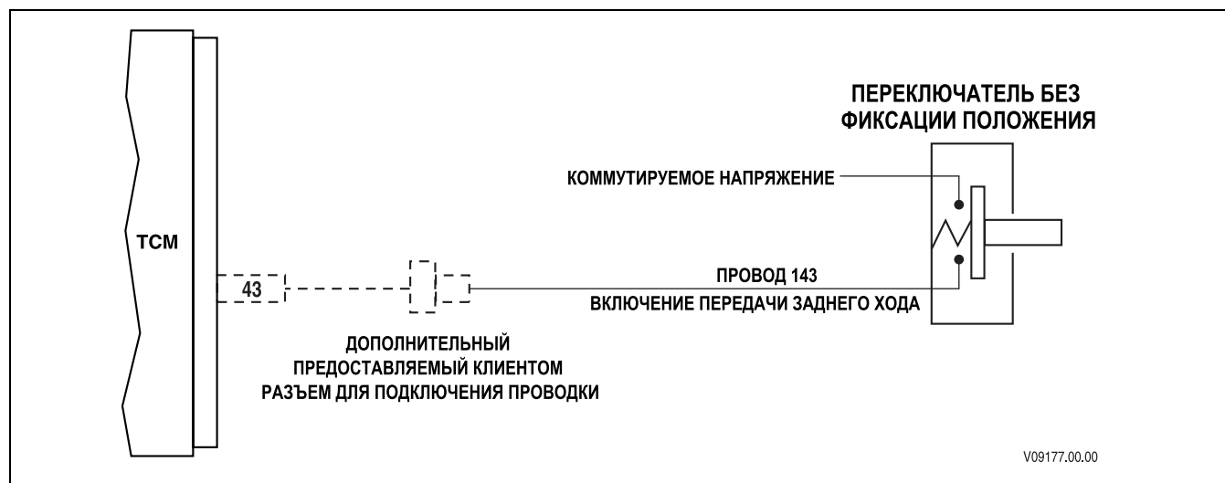
Рис. Р-24. Включение передачи заднего хода — подключение к питанию
