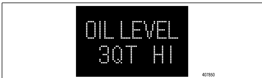
Рисунок 5–4. Индикация высокого уровня масла
