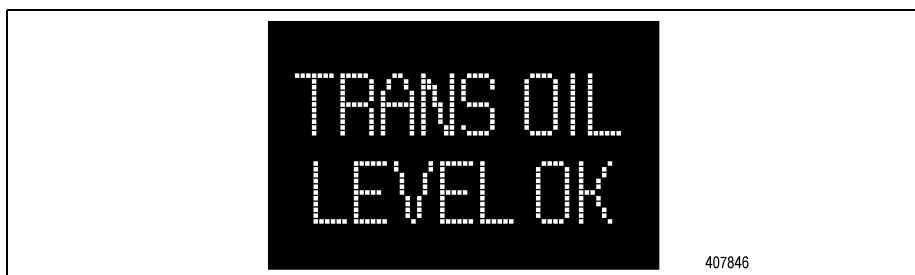
Рисунок 5–2. Индикация при правильном уровне масла
