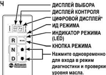
СЕМЬКОРОСТНОЙ, ПРАВОВОСТОРОННИЙ РЫЧАЖНЫЙ ПЕРЕКЛЮЧАТЕЛЬ ПЕРЕДАЧ
