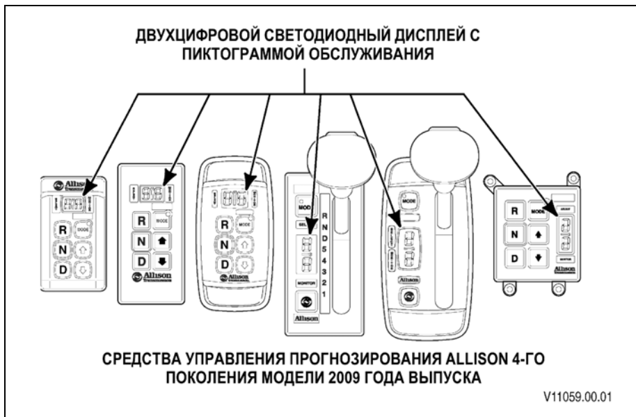
Рисунок 7–2. Типичные рычаги переключения передач со средствами управления системы Prognostics компании Allison 4-го поколения с цифровыми дисплеями «SELECT» и «MONITOR» и индикатором технического обслуживания транспортного средства.
