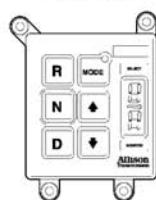
ШЕСТИКОРОСТНОЙ, ЛЕВОСТОРОННИЙ РЫЧАЖНЫЙ ПЕРЕКЛЮЧАТЕЛЬ ПЕРЕДАЧ
