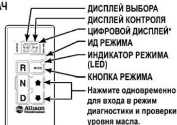
СЕМИСКОРОСТНОЙ, ПРАВОСТОРОННИЙ РЫЧАЖНЫЙ ПЕРЕКЛЮЧАТЕЛЬ ПЕРЕДАЧ
